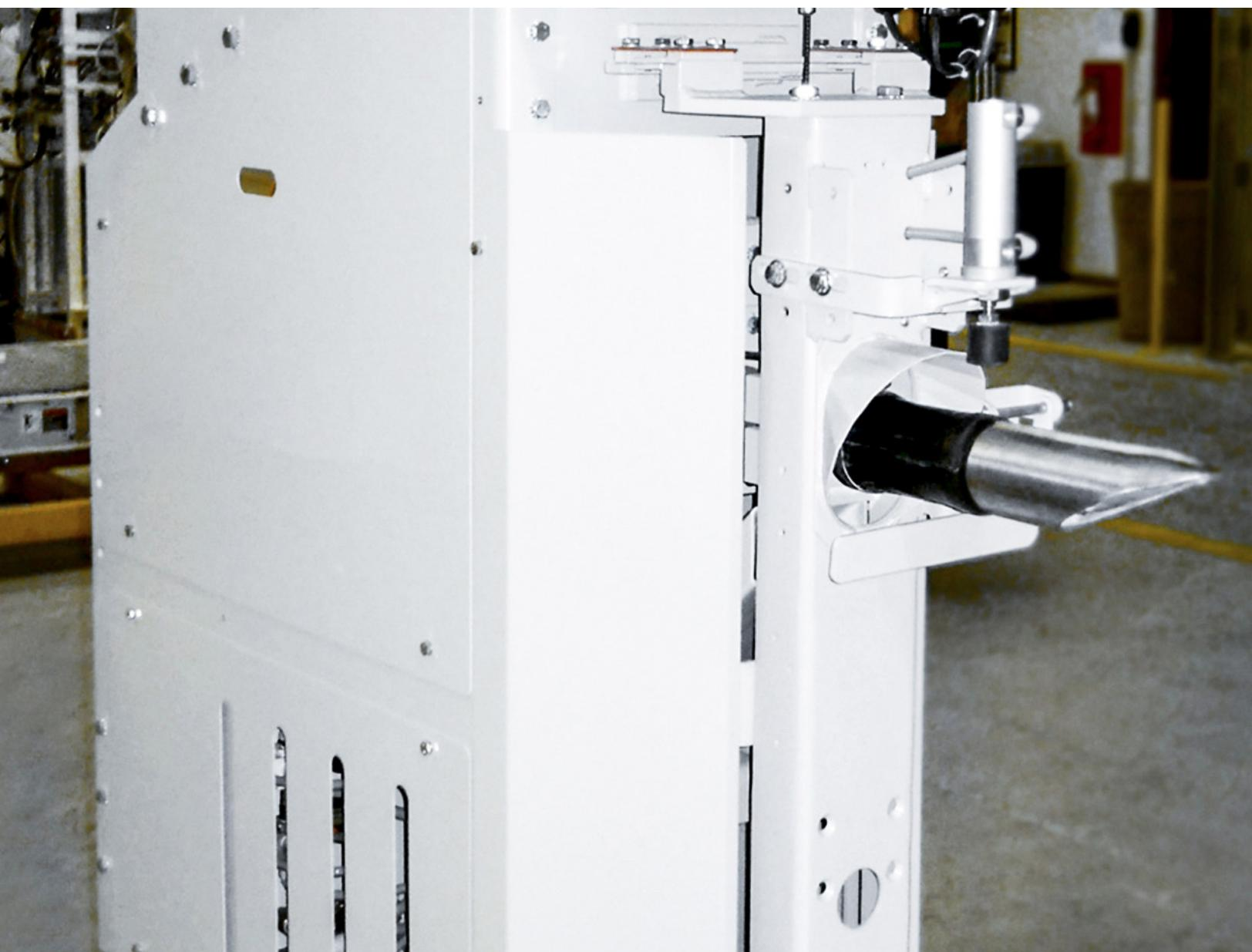
Ensacheuse à remplissage par pression d'air
